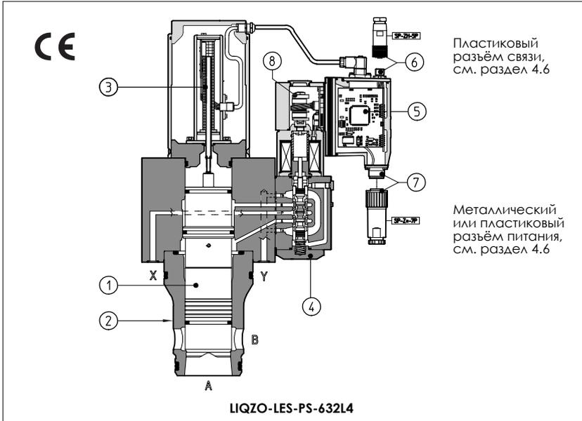
LIQZO - 2-х линейные пропорциональные картриджные клапаны, разработанные для установки в блоки и обеспечивают возможность управления расходом в зависимости от электронных опорных сигналов. Клапаны работают совместно с электронными драйверами, см. раздел [8], которые обеспечивают возможность регулировки положения основного золотника в зависимости от показаний опорного сигнала, поступающего от узла контроля и управления машины.
